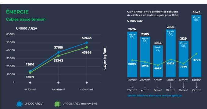
Calcul effectué pour une longueur de 100m en considérant une utilisation égale entre différentes sections sur un an (ampérage identique), un coût d'énergie égal à 0.15 €/kWh, et des émissions de CO2 égales à 0.40 kg / kWh.
